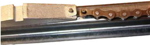
Placer l'autre bout de l'attache dans le raccord de chaîne
