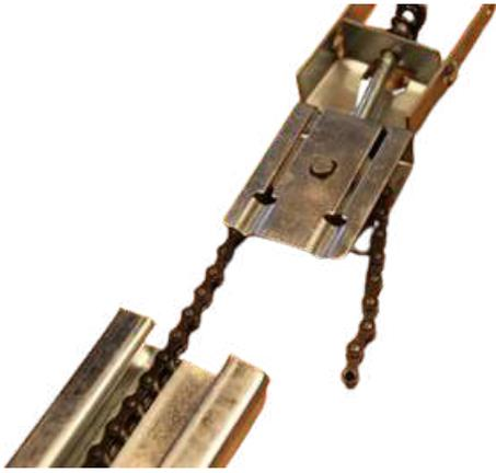
Faire passer la chaîne dans le tendeur et placer le tendeur dans les rails.
